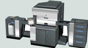
Цифровая печать — способ переноса изображения на материал посредством использования компьютеризированного оборудования. Именно для этого нужны специальные цифровые печатные машины, которые печатают из электронных файлов. Краски наносятся напрямую, без трафаретов или форм.
